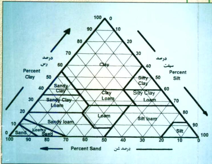
آنها تعیین نمود که بسته به مهارت شخص تعیین کننده خطای آن ممکن است کم یا زیاد باشد ولی به هر حال تخمین تقریباً خوبی را به دست می‌دهد که در صورت نیاز به دقت کافی و یا بیشتر میتوان مجدداً در آزمایشگاه به روش پیست و یا روش هیدرومتری درصد ذرات را بدست آورده و با استفاده از مثلث بافت خاک (که دارای دوازده کلاس بافتی میباشد) نوع بافت را مشخص نمود. جدول زیر تعریف کلی بافتهای مختلف را نشان میدهد.
